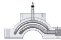
**Комбинация обогрева и охлаждения, приоритет - обогрев (жидкостное охлаждение подключается резьбовым соединением)**
